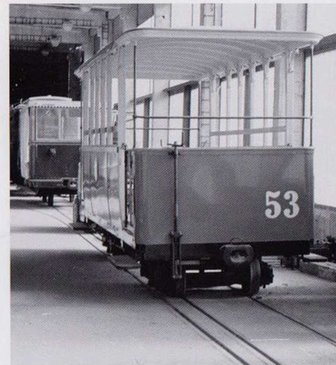
Teplický vlečný vůz č. 51, chybně opatřený č. 53, v depozitní hale Areálu MHD v Brně-Lišni dne 9. května 1985. Dobře jsou viditelné podvozky rozchodu 760 mm dosazené teprve po předání vozu do Hronce. Jelikož vůz v této podobě spíše dokumentoval provoz na lesní železnici, byl krátce poté odeslán na Vychylovku, kde nakonec podlehl zničujícímu požáru.
