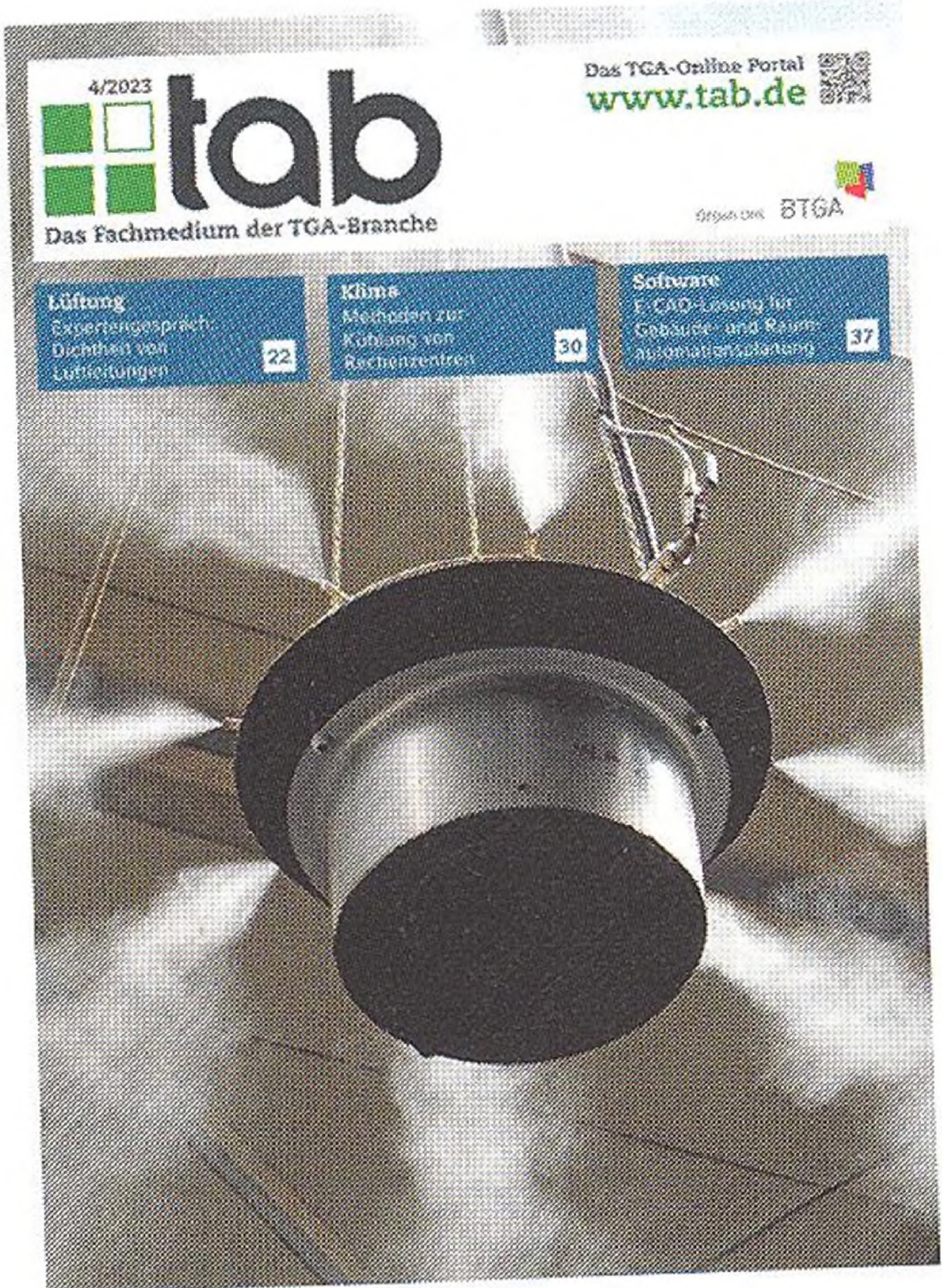
Titelbild Was da an der Decke hängt, hat einen doppelten Nutzen: Adiabate Verdunstungskühlung plus Einstellung der optimalen Luftfeuchtigkeit. Das Bild ist aus dem Beitrag von Condair Systems ab Seite 34.
