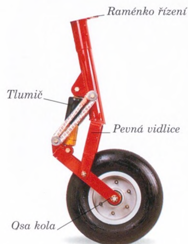
PŘÍDOVÝ PODVOZEK MODERNÍHO LEHKÉHO LETADLA
